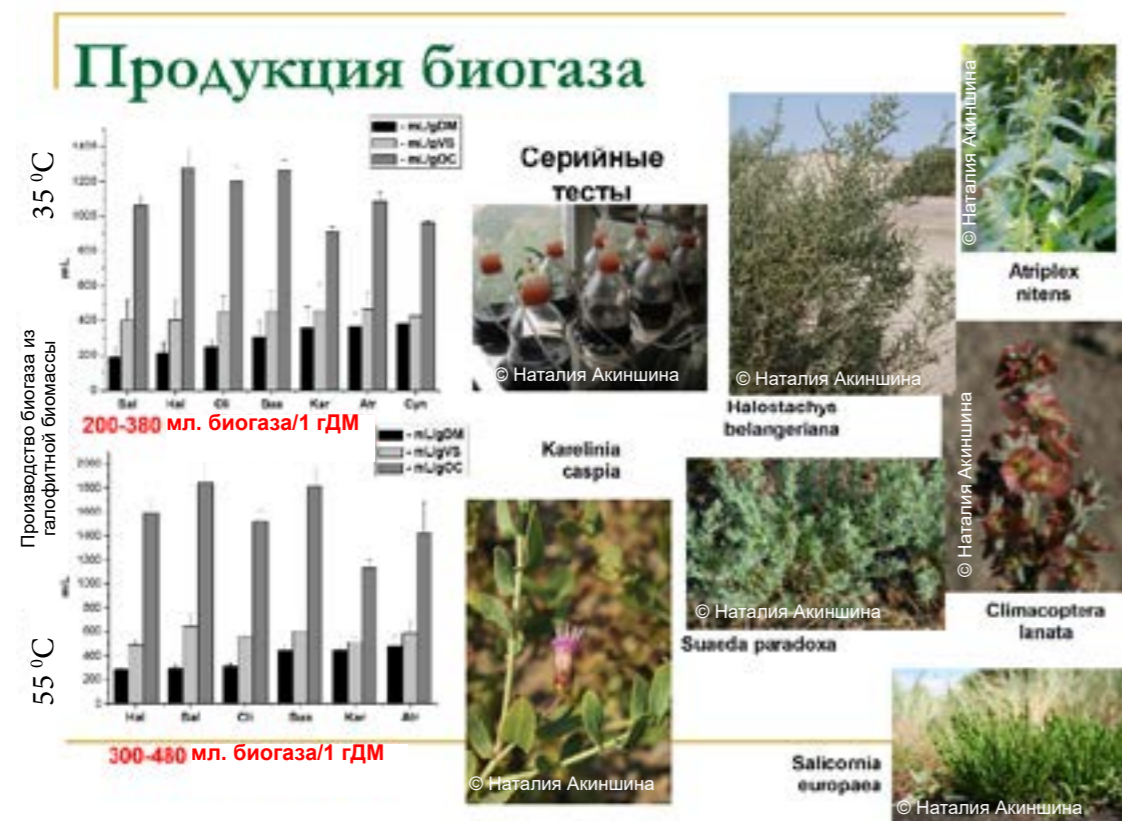
Рисунок 36. Лабораторные исследования по производству биогаза из галофитов
